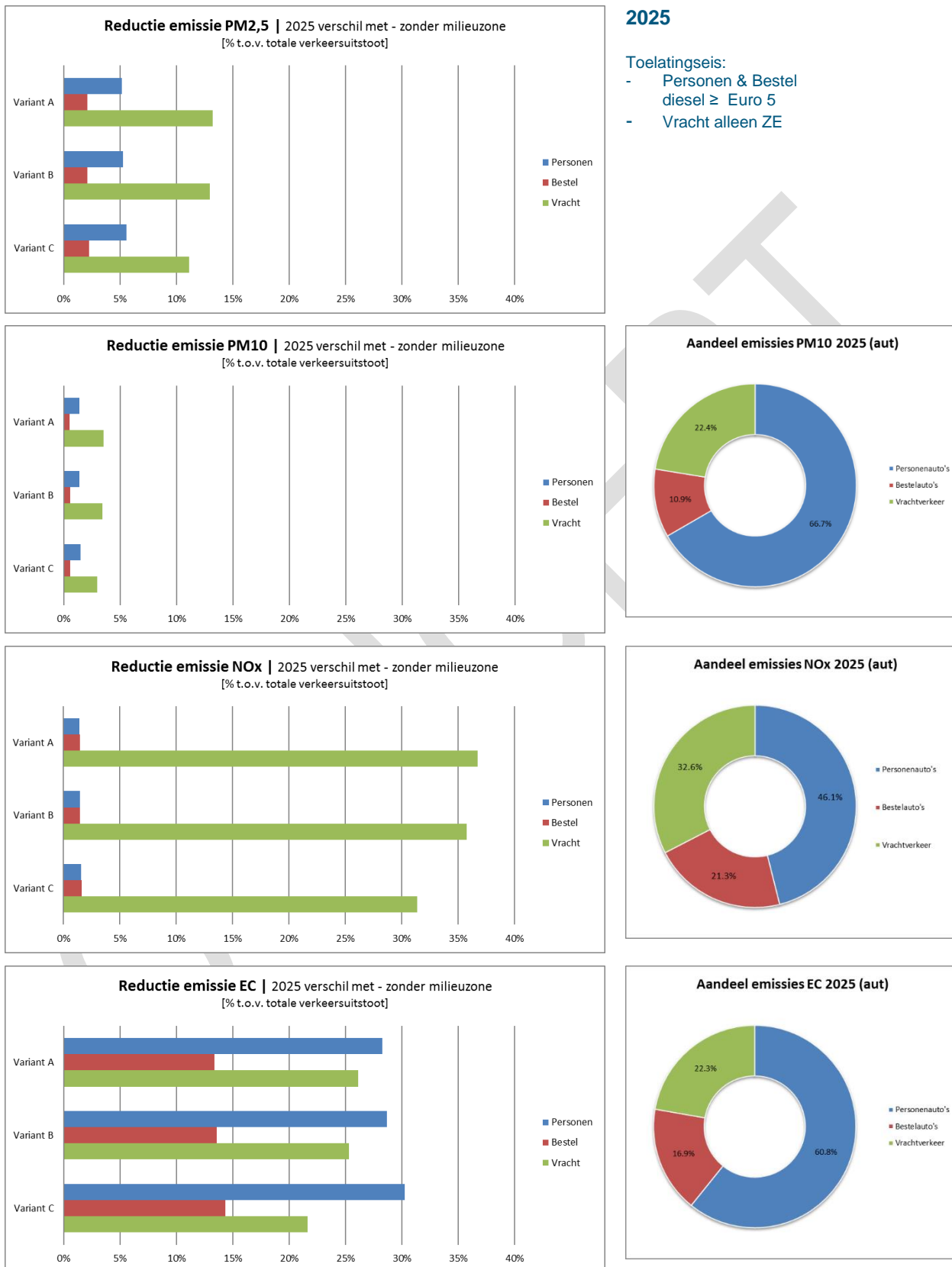
Figuur B1-5-3: Afname (%) van verkeersemissies Personen, Bestel, Vracht, op alle wegen binnen de milieuzone, t.o.v. autonoom. Per stof is de autonome verdeling van verkeersemissies per categorie weergegeven in taartdiagrammen
